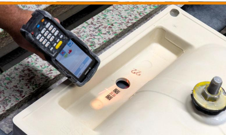
Mit einem Scan des keramischen Barcodes erhalten Mitarbeitende alle Informationen zu Auftrag und Bearbeitungsschritt.
